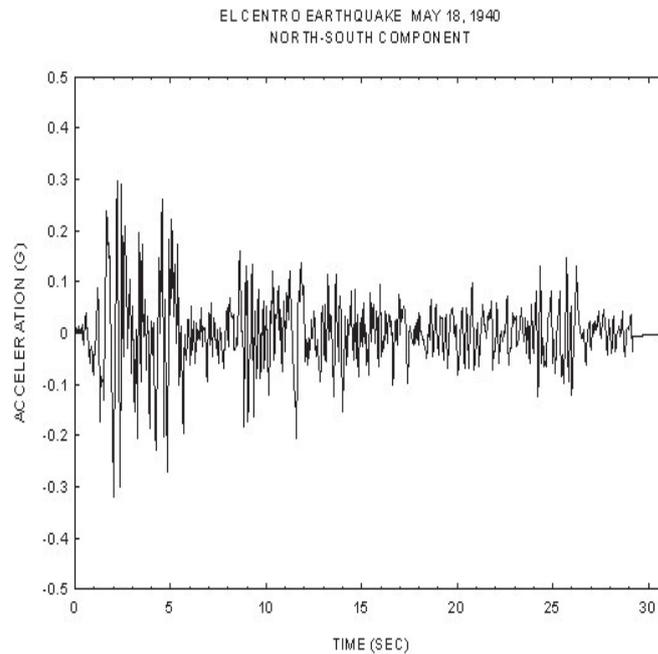
Figura 1: Registo do terremoto El Centro (Imperial Valley, EUA, costa do Pacífico). A aceleração foi medida na base do edifício El Centro Terminal Substation e está representada em  $\text{cm/s}^2$ .
